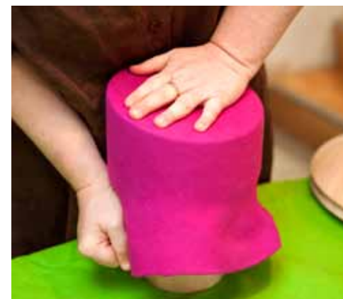
De vormloze vilten hoed wordt verwarmd met stoom en over een houten mal getrokken.
